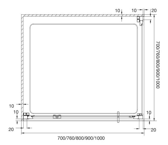
Step 1 MAKE SURE THE TRAY IS LEVEL, USING A SPIRIT LEVEL, BEFORE INSTALLING THIS SHOWER PANEL / DOOR
